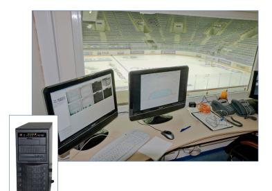
Система видеофиксации «Форвард Рефери» поставляется в виде сервера (системного блока с установленным аппаратным и программным обеспечением). В состав поставки входят средства коммутации для подключения видеокамер. Для начала работы достаточно просто подсоединить видеокамеры. Также возможна поставка полной системы видеосудейства («под ключ») в комплекте с камерами (подробнее см. пункт 12 ниже).
