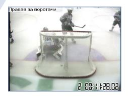
Система «Форвард Рефери» позволяет «впечатывать» время игры в видеокадры. Метки времени отображаются как при просмотре событий по ходу игры, так и в видеороликах, подготовленных для отчета. Для меток можно выбрать положение в кадре, шрифт, размер и цвет символов.
