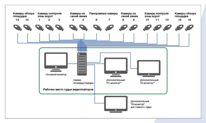
«Форвард Рефери» — программно-аппаратный комплекс, предназначенный для оперативного просмотра спорных моментов во время хоккейных матчей. Система позволяет просматривать повторы в режиме покадрового просмотра (50 изображений на секунду). Просмотр событий происходит без остановки записи игры. По результатам игры можно сформировать видеоотчет по спорным моментам.
