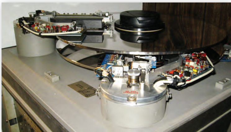
Первая в мире телевизионная система замедленных повторов – Ampex HS-100
